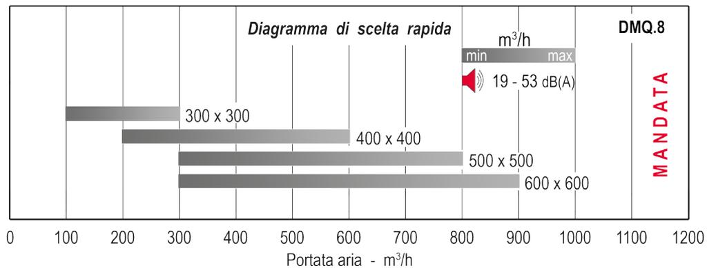
Il valore consigliato delle velocità dell'aria attraverso la superficie effettiva deve essere adatto ad un lancio medio con velocità finale in ambiente comunque inferiore a 0,3 m/s, per un valore della potenza sonora compreso tra <20 e 53 dB(A).
