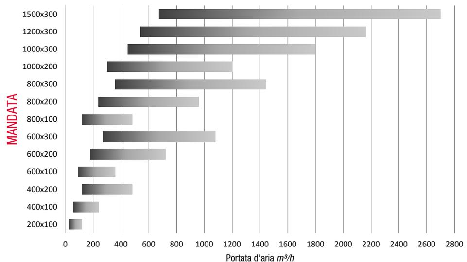
Il valore consigliato delle portate dell'aria per singolo microugello può variare da 15 a 60 m³/h, per un valore della potenza sonora compreso tra 26 e 45 dB(A).
