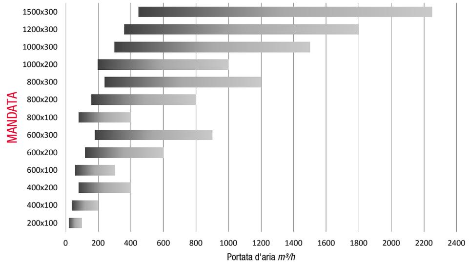
Il valore consigliato delle portate dell'aria per singolo microugello può variare da 10 a 50 m³/h, per un valore della potenza sonora compreso tra 20 e 35 dB(A).
