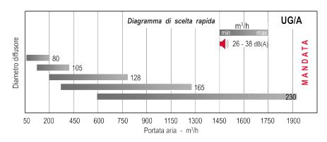
Il valore consigliato delle velocità dell'aria attraverso la superficie effettiva può variare da 5 a 12 m/s, per un livello di potenza sonora compreso tra 26 e 38 dB(A).
